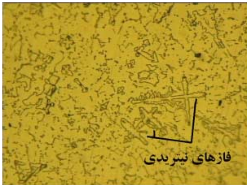
شکل ۱- فازهای نیتریدی با ساختار صلیبی در آلیاژ با بزرگنمایی ۱۰۰۰
