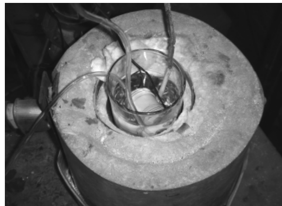
شکل ۷: مجموعه حمام آب، هیتر و ترموکوپل
