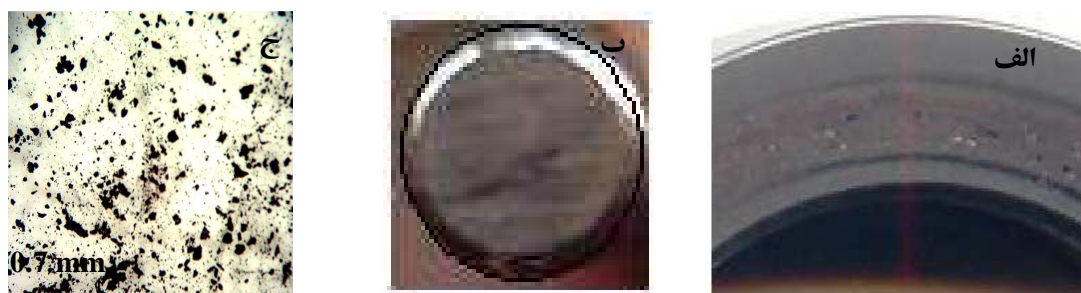
شکل (۱۰) الف) \times 7 رد سایش نمونه TiC-NiAl (ب) \times 7 سطح سایش بین ج) \times 14 ذرات حاصل از سایش.
