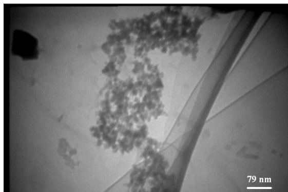
شکل ۱۰- عکس TEM نمونه محتوی چهار گرم CTAB، T=300^{\circ}C ، t=2h
