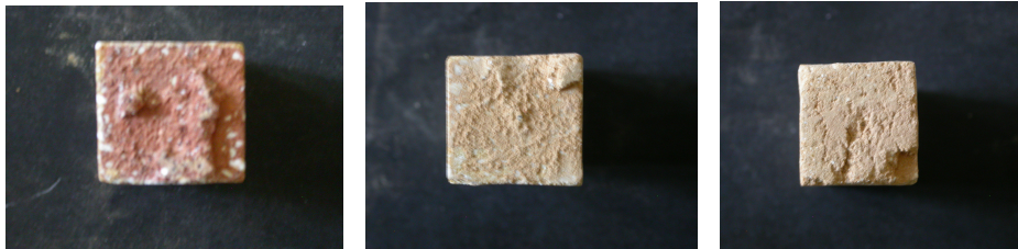
شکل ۵: تصویری از سطح مقطع پیوندی نمونه‌های تحت آزمایش استحکام پیوندی (خمشی سه نقطه‌ای)
