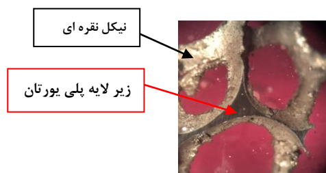
شکل ۱- لایه نازک نیکل رسوب داده شده به روش الکترولس
