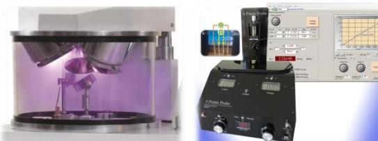
شکل ۲: دستگاه اسپاترینگ (سمت چپ) و دستگاه مقاومت سنج ۴ پراب (سمت راست) که در این پژوهه استفاده شده است.
